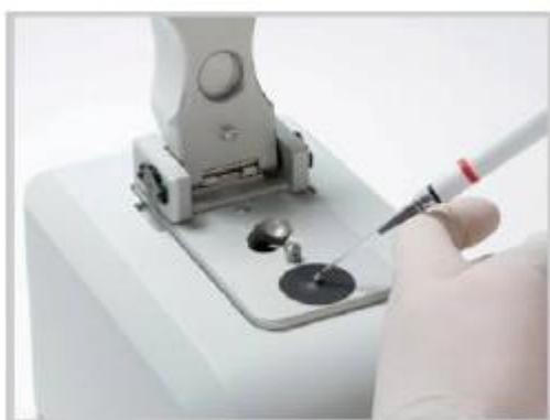
2. 放下样品臂，使用电脑上的软件开始吸光值检测。在上下两个光纤之间会自动拉出一个样品柱，然后进行检测。
